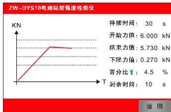
图 3.9 定荷载模式下的折线图界面
